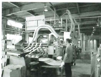
▲波状の中芯に片面だけ原紙を貼り合わせた片面段ボール、両面段ボールともに製造可能
