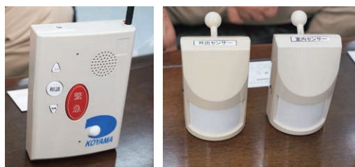
写真左：ハンズフリーで話すことができるレシーバー 写真右：人の動きを感知する安否センサー
