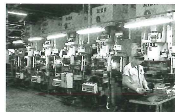
▲110tプレス用ロボットライン
