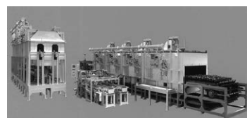
▲ウォーキングビーム式連続焼入炉 コンベアチェーン式連続焼戻炉
