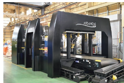
▲URANOSの全体像 搬送ライン上にセンシングユニット（カメラ、センサー）と、2種類のアームロボット（多関節ロボット、パラレルリンクロボット）を搭載
