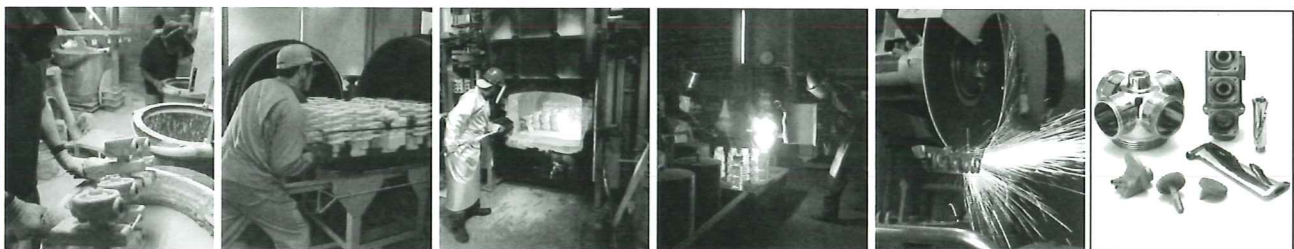
ロストワックス法の工程 (ワックス模型のコーティング～製品完成まで)
