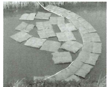
▲もみから炭が約2L入っている油吸着材「スーパーオイルワイパー」。これで、約1Lの油を吸着する
