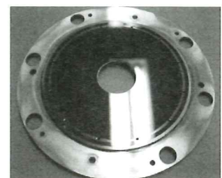
▲真空熱処理、イオンプレーティング等を行った光ディスク成形金型
