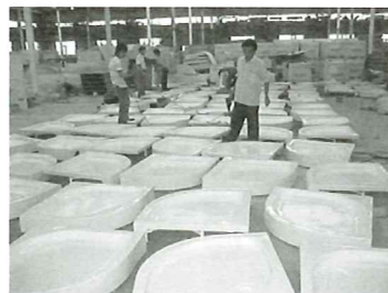
▲同社オリジナルの防水パンを製作し、水漏れを防止
