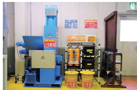
▲マグネ切粉圧縮機、消火剤
