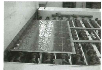
▲印刷技術を応用して、回路網を焼き付ける
