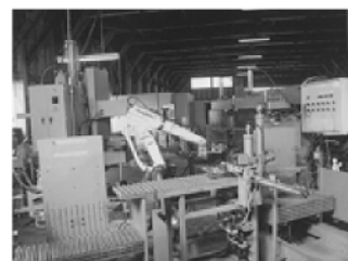
▲ロボットによる ブローチ無人加工システム
